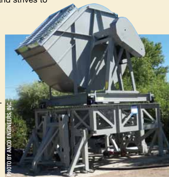
73-AFSW fan being shake table tested..
